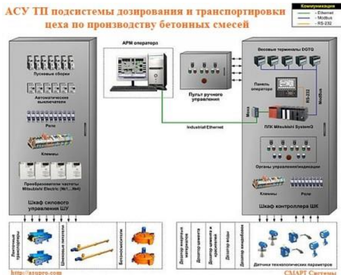
Рисунок 2.11 - АСУ ТП перемещения и дозирования бетонных смесей
